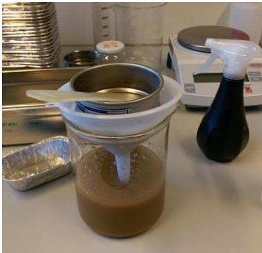
Figure 10: Illustration d'un tamisage par voie humide dans le protocole de fractionnement physique d'un échantillon de sols.
